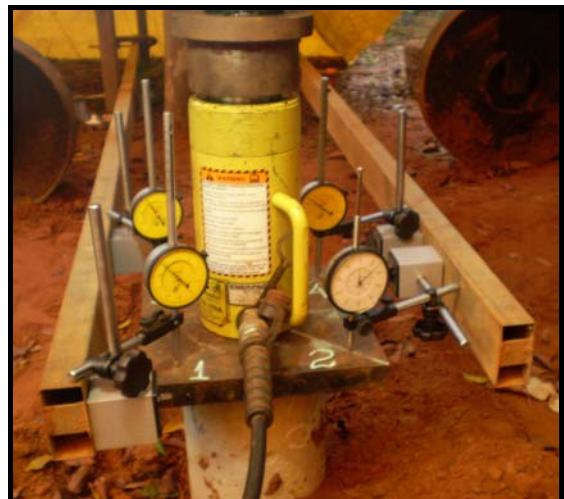
Figura 32 – Instalação dos extensômetros.
